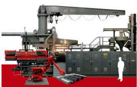
Fabricación de Palets mediante el proceso de Inyección a baja presión de Plastic Mix o restos procedentes del pulper en el reciclado de Tetrabricks.
